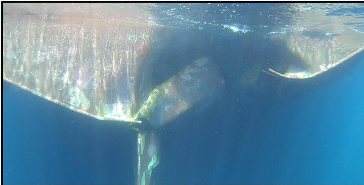
*Рисунок 21. Повреждения корпуса танкера “ANDREA VICTORY”*
