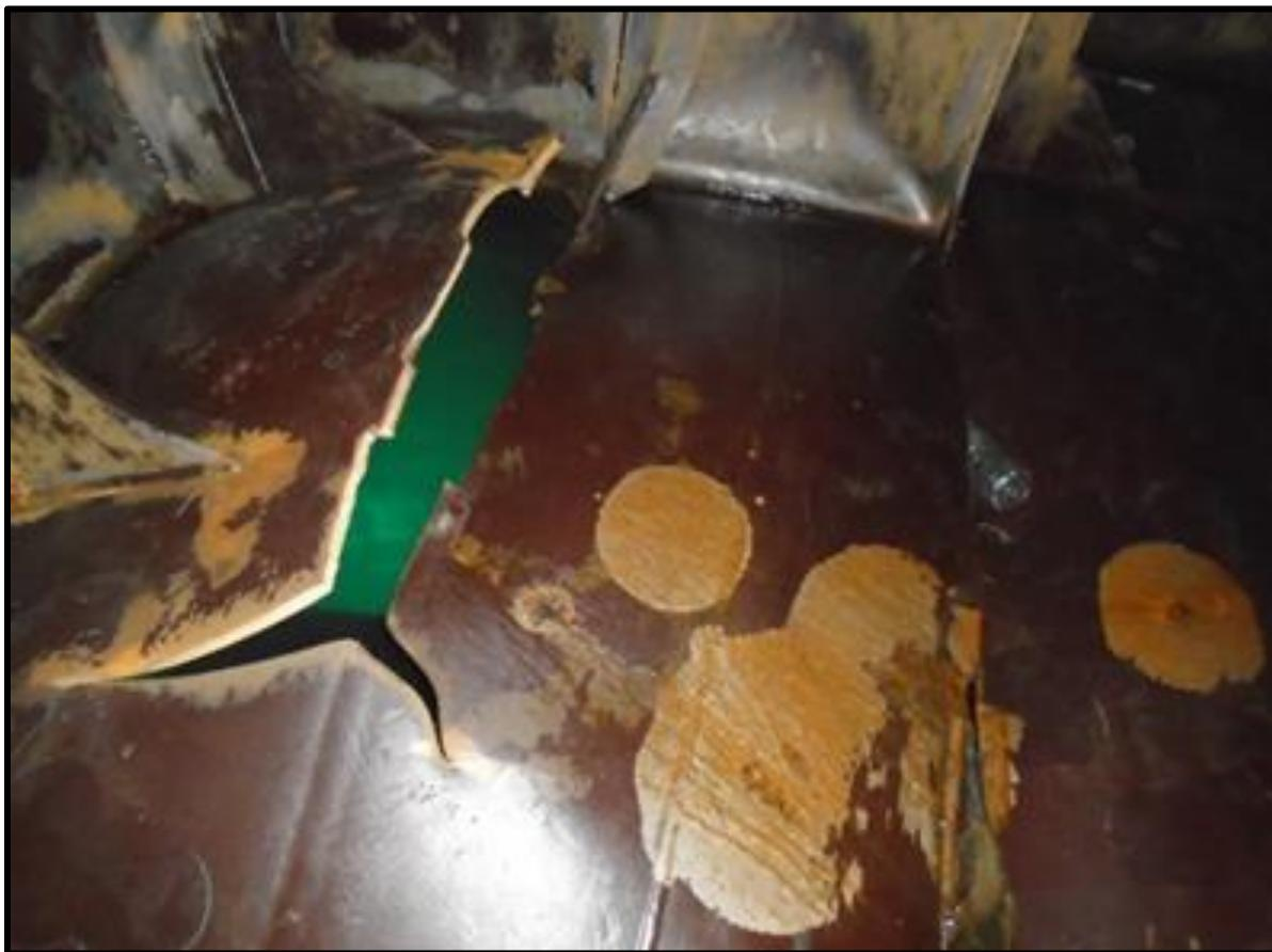
*Рисунок 12. Повреждения на полу машинного отделения танкера "AL MARZOQAN"*
