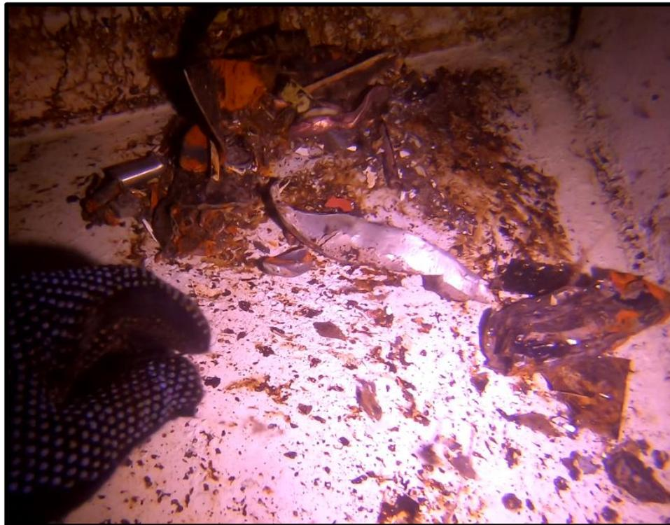
*Рисунок 4. Извлечение обломков инородного объекта из внутренней части танкера “AMJAD”*
