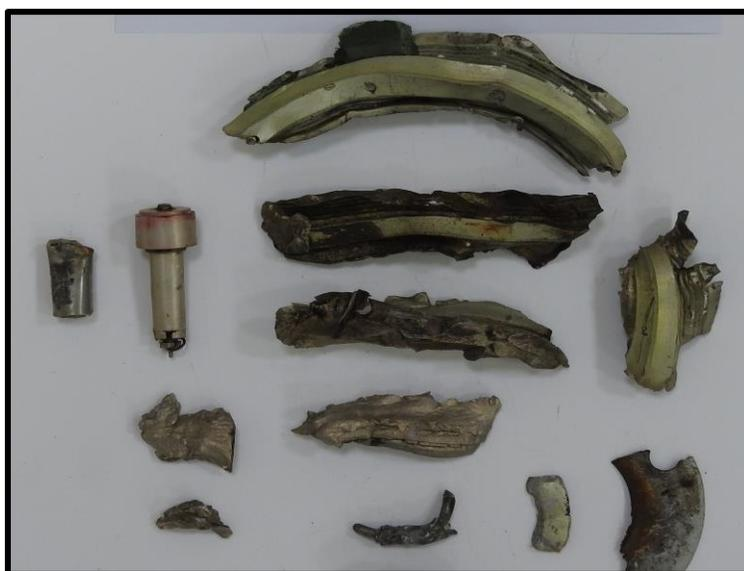
*Рисунок 5. Обломки инородного объекта, обнаруженные на танкере “AMJAD”*
