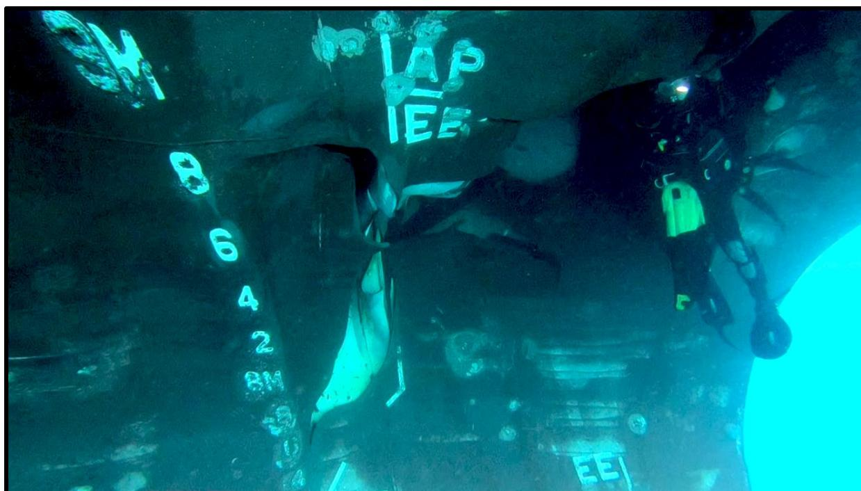
*Рисунок 11. Водолаз рядом с поврежденным корпусом танкера "AL MARZOQAH"*
