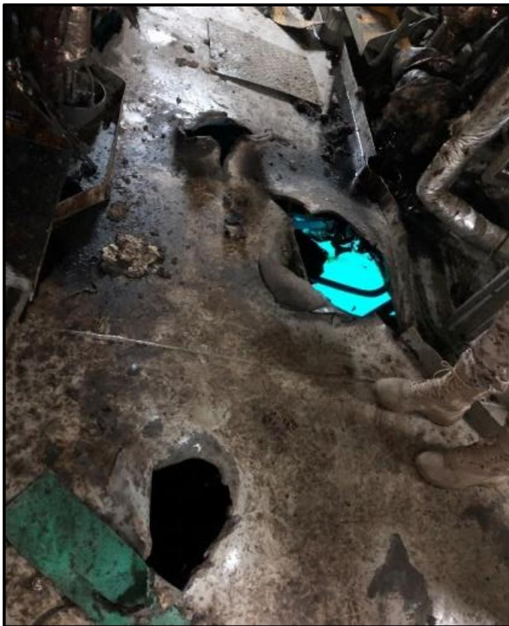
*Рисунок 3. Повреждения, полученные танкером “AMJAD” под сепараторной камерой в машинном отделении*
