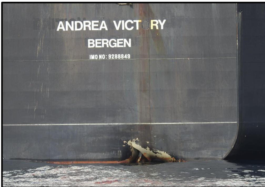
*Рисунок 20. Внешняя часть корпуса судна "ANDREA VICTORY" с полученными повреждениями*
