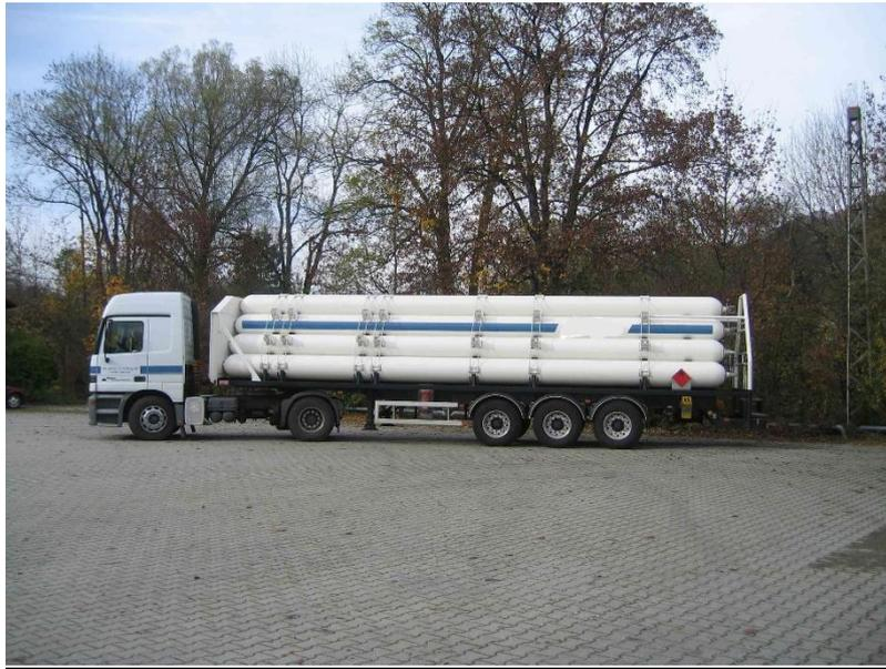
Véhicule-batterie construit avec des tubes en acier sans soudure
