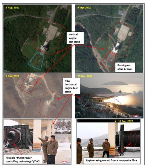
Figura IV Plataformas de ensayos de motores en Sohae
