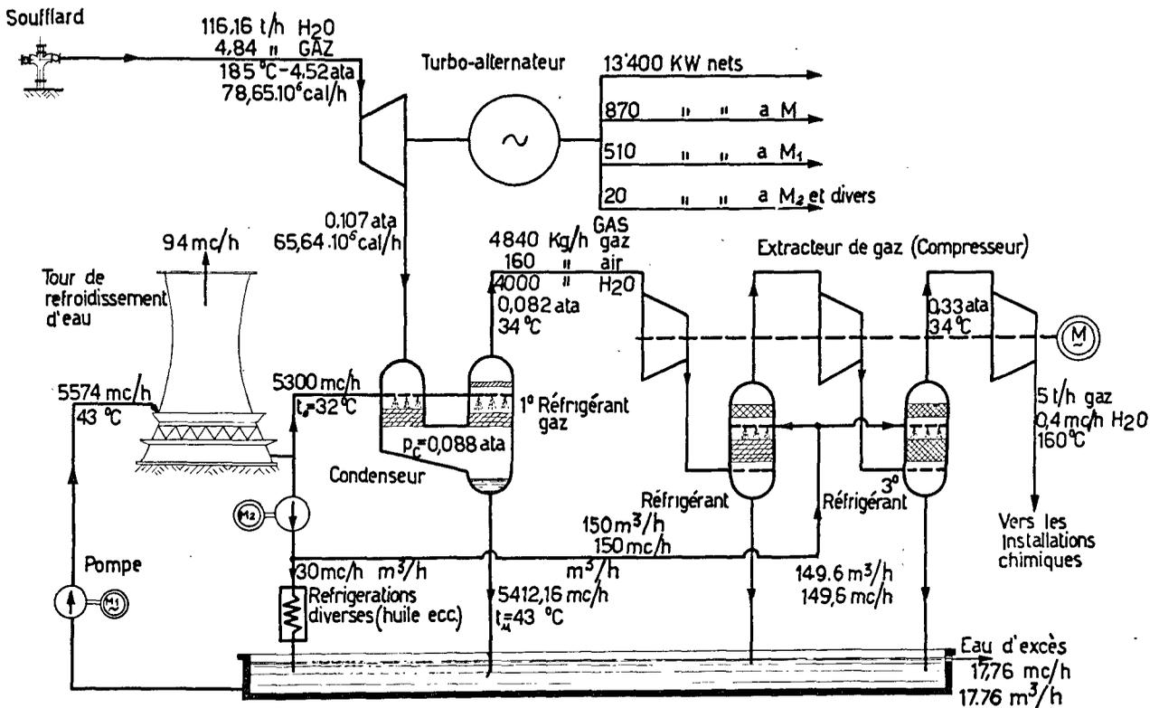
Figure 3. Installation à vapeur naturelle, à condensation (schéma 3)
