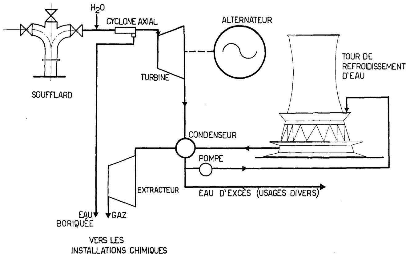
Figure 4. Installation avec lavage de la vapeur (schéma 4)
