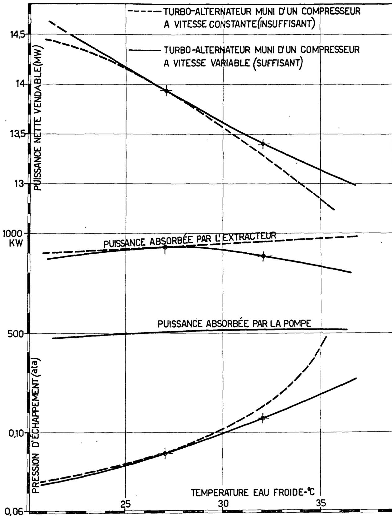
Figure 12. Exploitation turbo-alternateurs à condensation, à vapeur naturelle
