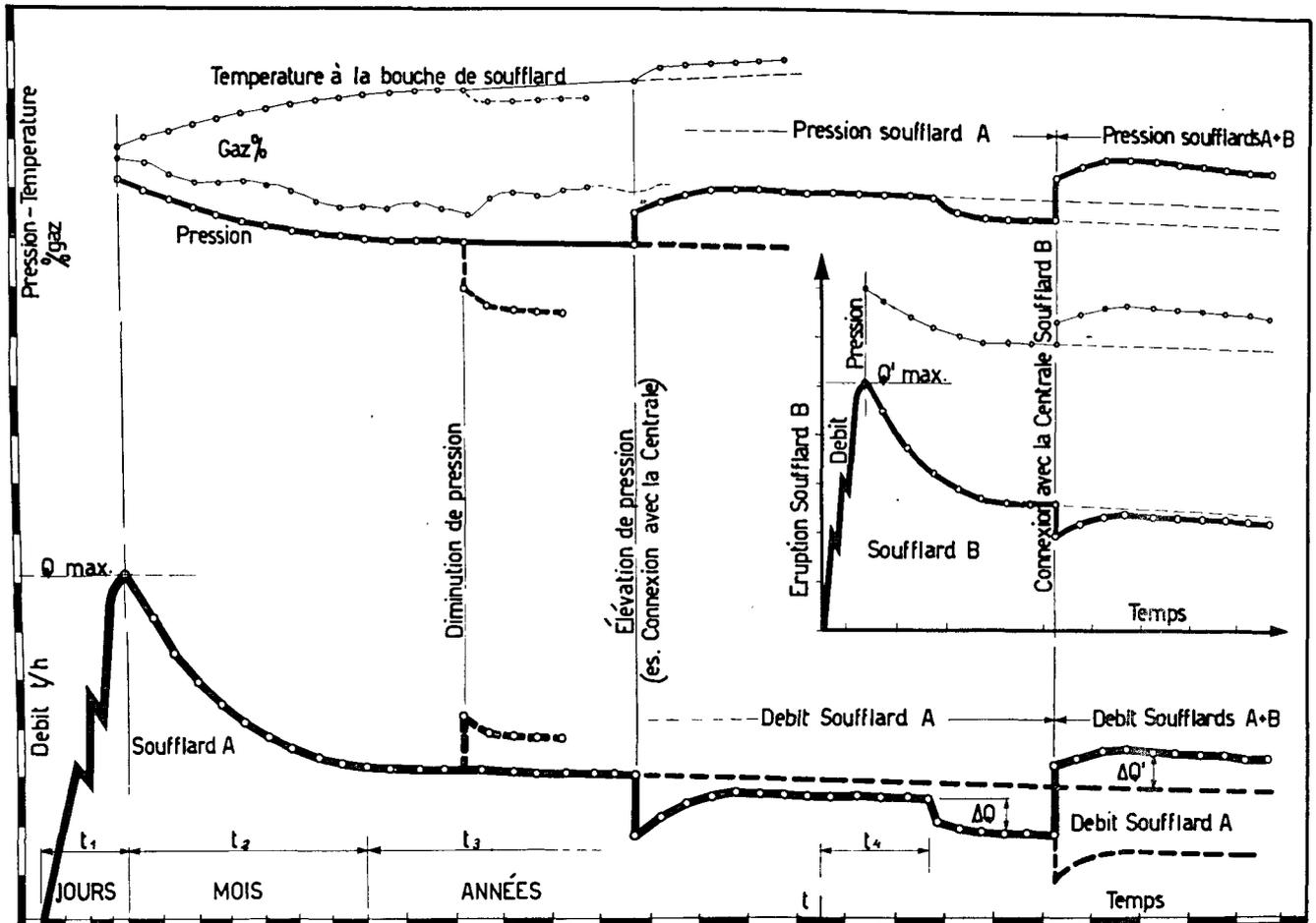
Figure 13. Exploitation des soufflards dépourvus d'appareils de fermeture
