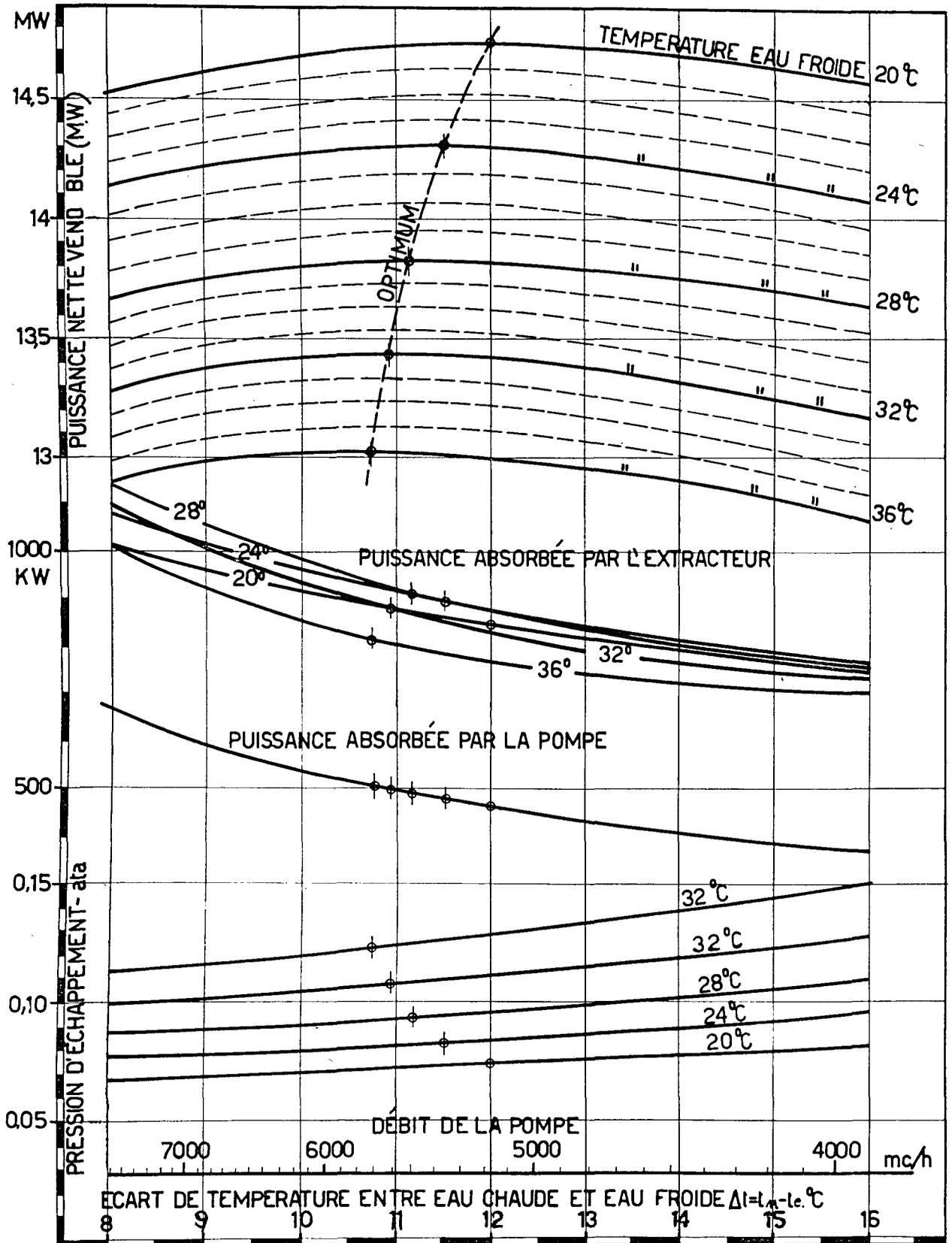
Figure 11. Recherche de l'optimum pour les auxiliaires d'un groupe à vapeur naturelle
