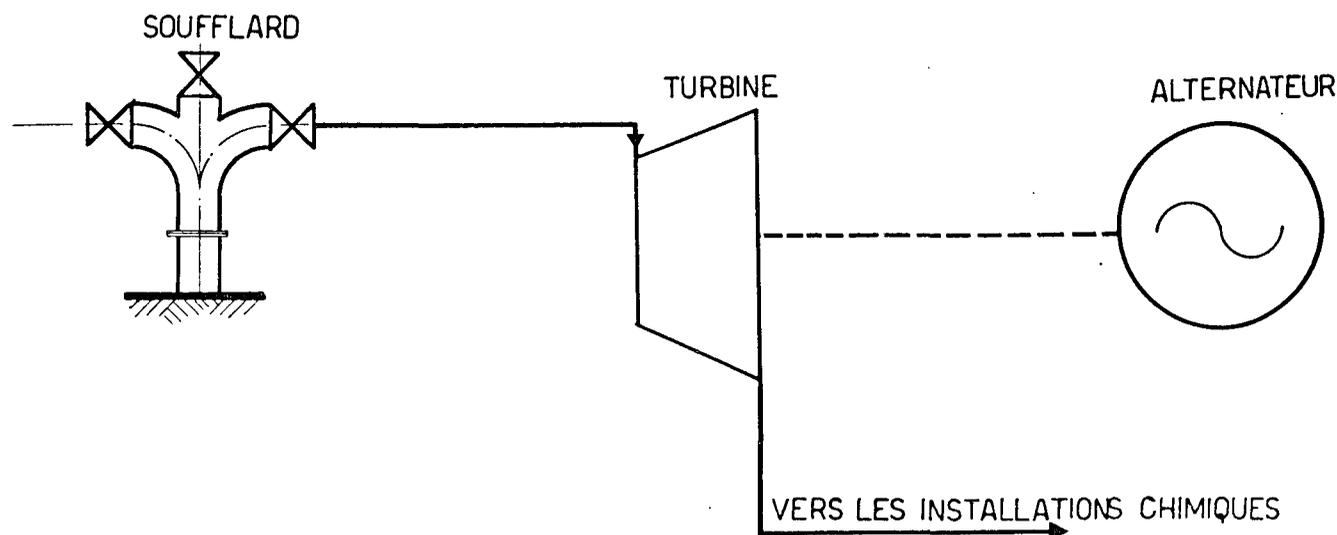
Figure 1. Installation à vapeur naturelle, à échappement libre (schéma 1)
