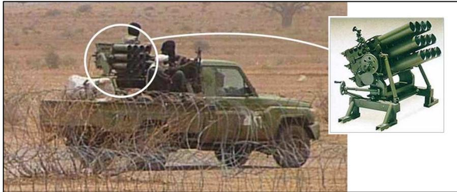
٧٣ - وليست الصورة على قدر كاف من الجودة لتحديد نوع وطراز قاذفة الصواريخ المتعددة الفوهات عيار ١٠٧ ملم. ومن المحتمل أن تكون قاذفة صواريخ متعددة الفوهات من طراز TAKA BRY01 عيار ١٠٧ ملم التي تنتجها هيئة التصنيع الحربي في السودان<sup>(٤٨)</sup>
